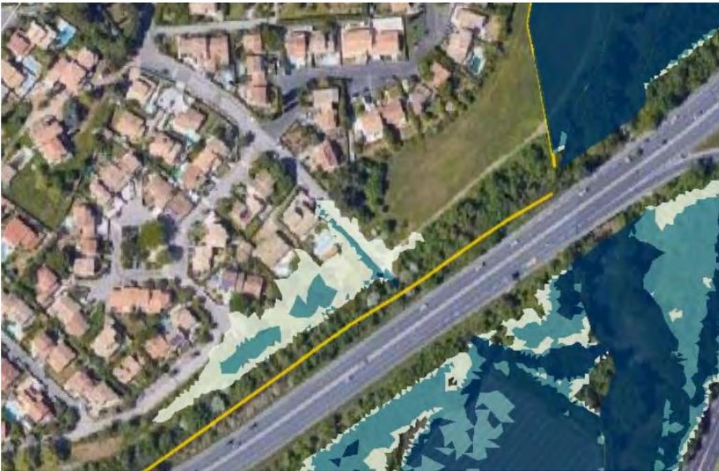
Pour un débit d'environ 340 m<sup>3</sup>/s et une cote de 31.5 m NGF au droit de la station de mesure, une grande partie de la zone en aval de la rue des Mimosas est inondée par remontée de la Mosson dans le ruisseau de la Plaine.
