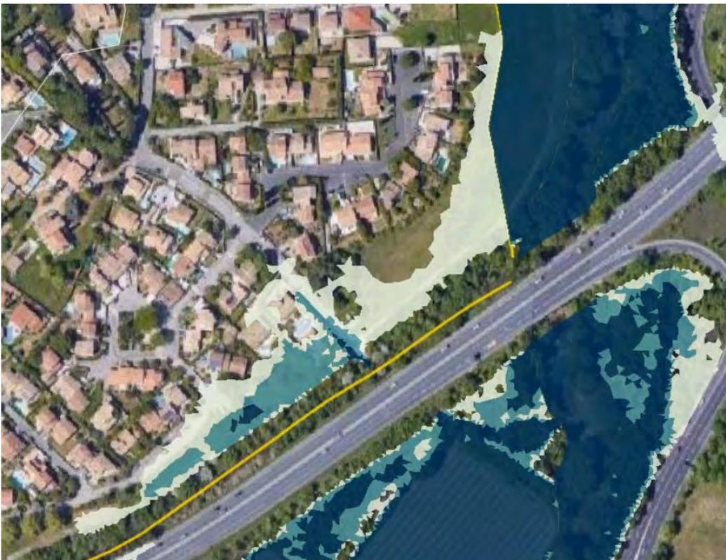
En l'état projet, le risque d'inondation urbaine lié à la remontée de la Mosson par l'ouvrage de franchissement de la RN109 par le ruisseau de la Plaine reste sensiblement identique à l'état initial pour les crues de la Mosson inférieures au niveau de protection de ce secteur par l'ouvrage digue projeté.
