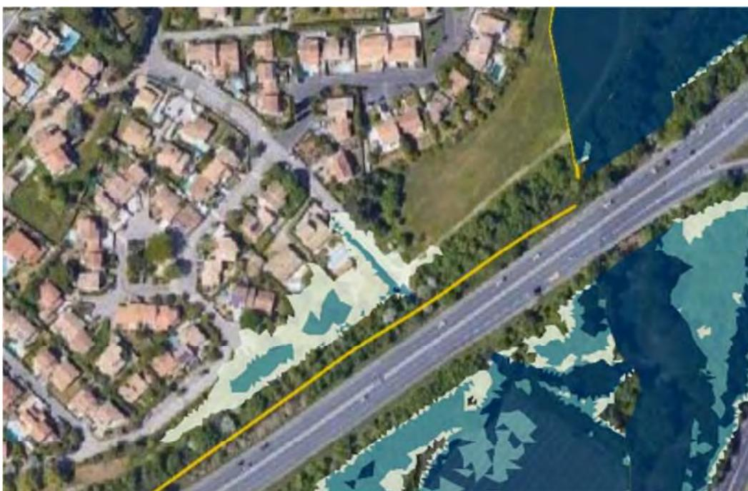
Pour un débit d'environ 340 m<sup>3</sup>/s et une cote de 31.5 m NGF au droit de la station de mesure, une grande partie de la zone est inondée par remontée de la Mosson dans le ruisseau de la Plaine.
