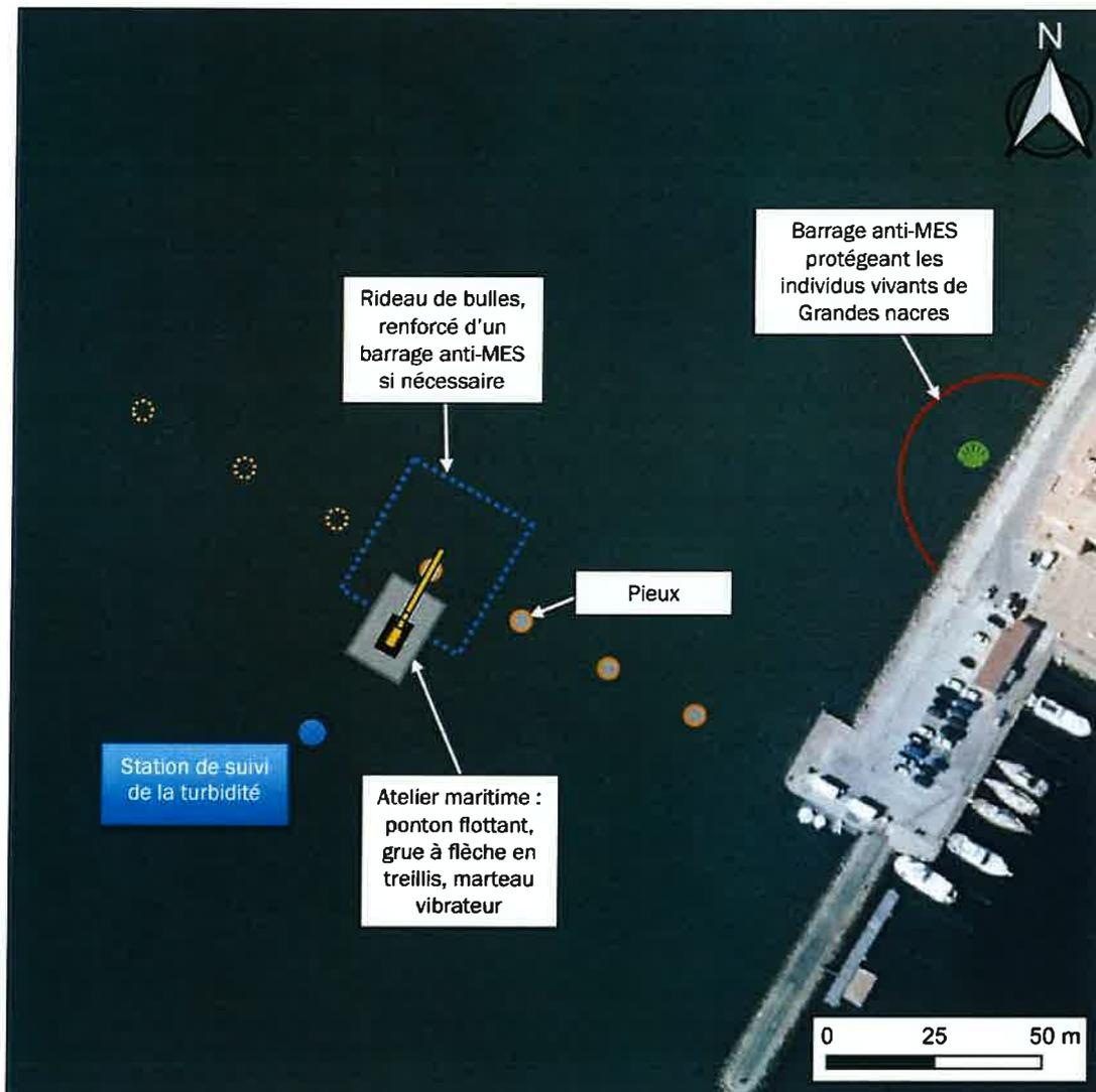
Figure 3 : Schéma de principe des travaux de pose des pieux et des mesures de protection / suivi de la qualité de l'eau
