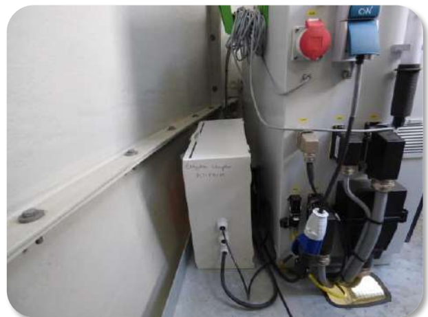
Position finale du microphone ultrasonique (à l'extérieur de la nacelle) et du coffret IP66 (dans la nacelle)
