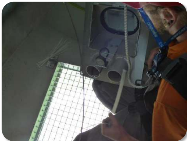
Fixation et position du micro sur le spot d'éclairage à l'extérieur de la nacelle
