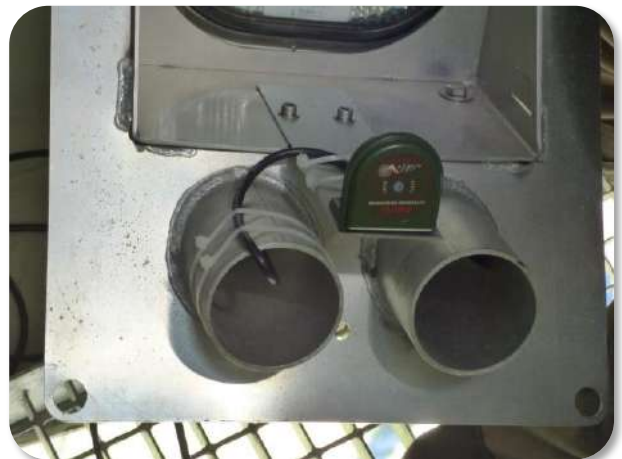
Fixation et position du micro sur le spot d'éclairage à l'extérieur de la nacelle
