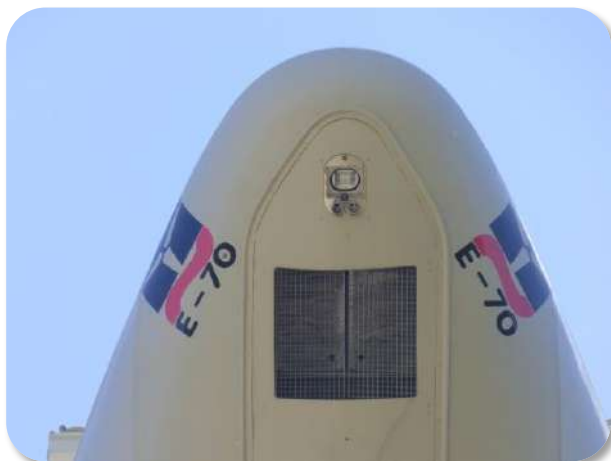
Position finale du microphone ultrasonique (à l'extérieur de la nacelle) et du coffret IP66 (dans la nacelle)
