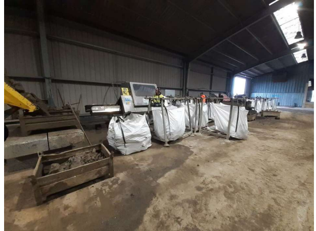
Machines utilisées pour le sciage des pavés pré-criblés
